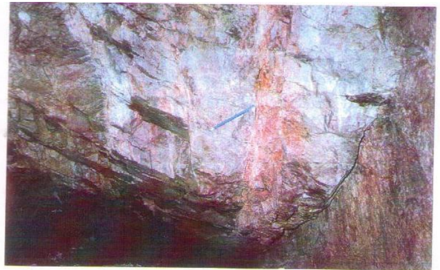
Fotografía 4. Nivel 3, falla 2. Se aprecia ramaleo de cuarzo paralelo y al bajo de la falla óxidos de Fe en roca silicificada.
